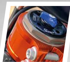
Suspensão duplo cartucho SZC com ajustes de compressão e retorno
