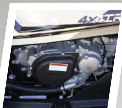
Motor 4 tempos SOHC com 40cv
