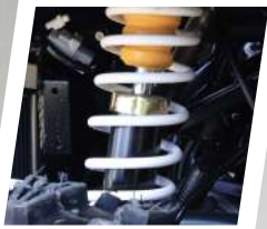
Suspensão independente McPherson
