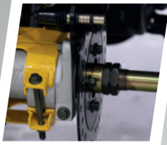
Freios a disco (dianteiro hidráulico ventilado)
