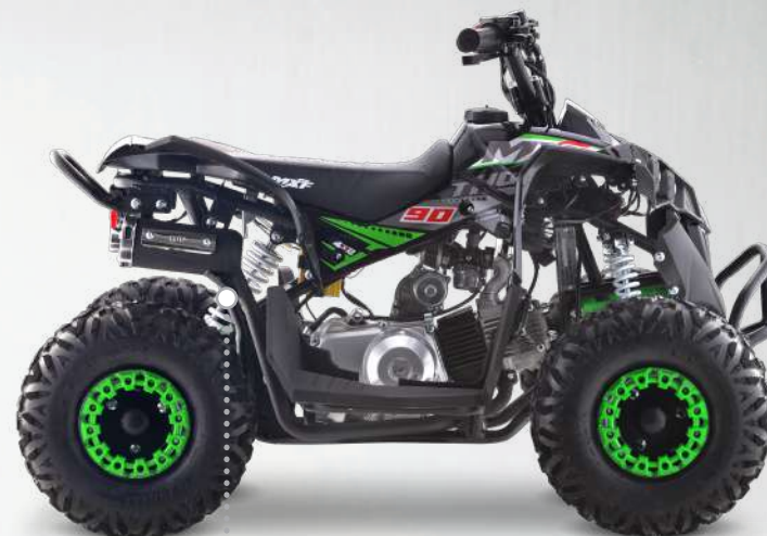
Suspensão traseira: sistema monoshock amortecedor hidráulico
