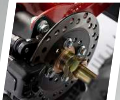
Freio a disco (traseiro hidráulico)
