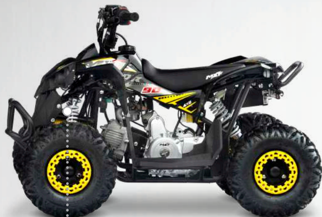
Suspensão traseira: sistema monoshock amortecedor hidráulico
