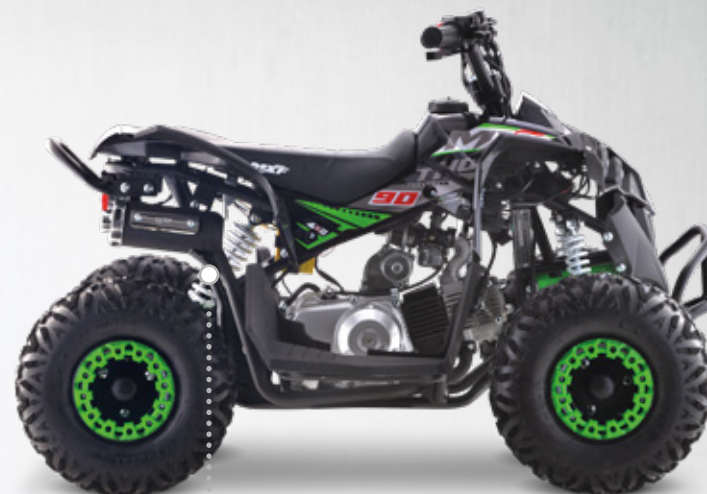
Suspensão traseira: sistema monoshock amortecedor hidráulico
