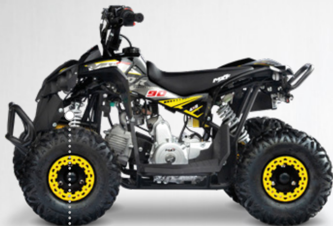
Suspensão traseira: sistema monoshock amortecedor hidráulico
