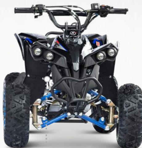
Motor 49cc - 4 tempos, monocilíndrico a gasolina
