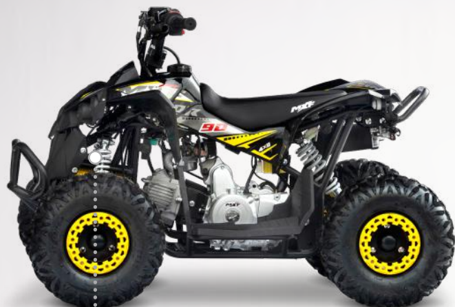
Suspensão traseira: sistema monoshock amortecedor hidráulico
